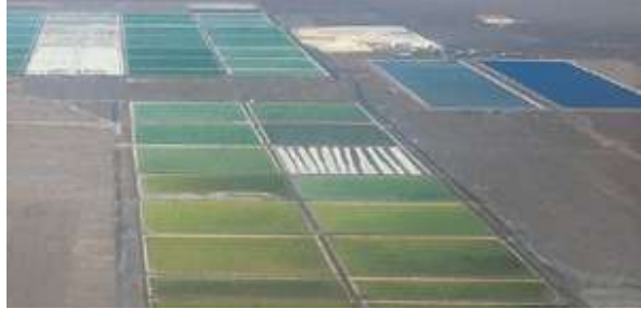
□ Pozas de evaporación solar en el Salar de Atacama.
