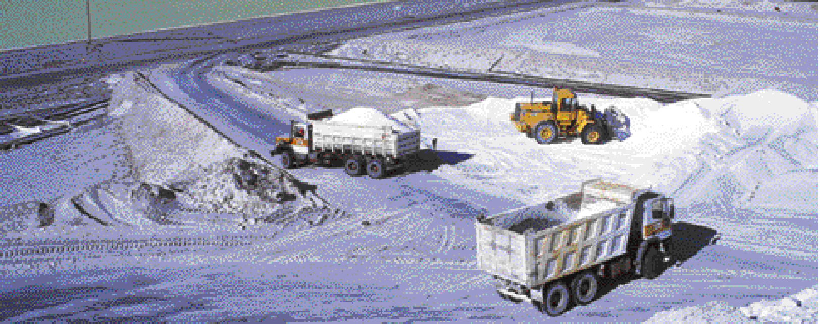
Transporte y carguío de sales en el Salar de Atacama.
